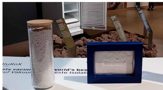
▣ Bild 2: Perlit – Rohstoff und Vakuumisolierung (enthält gemahlenen Perlit)
